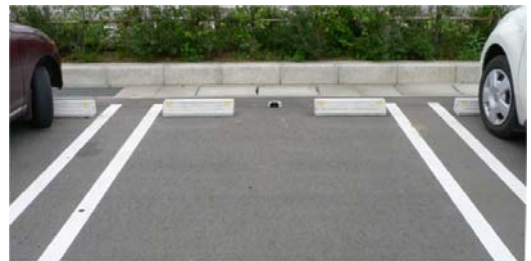
下写真) 屋外使用の可能な床置き式超音波センサEP-I
